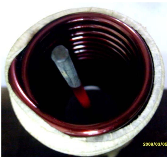
รูปที่ 4.12 การทดสอบการเรโซแนนซ์ การวางเหล็กตรงกลาง ขนาด 6 มิลลิเมตร
