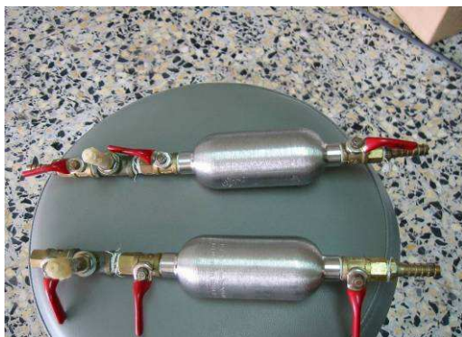
ค. อุปกรณ์บรรจุแก๊สเชื้อเพลิง (บรรจุแก๊สเพื่อนำไปวิเคราะห์กับเครื่อง GC)
