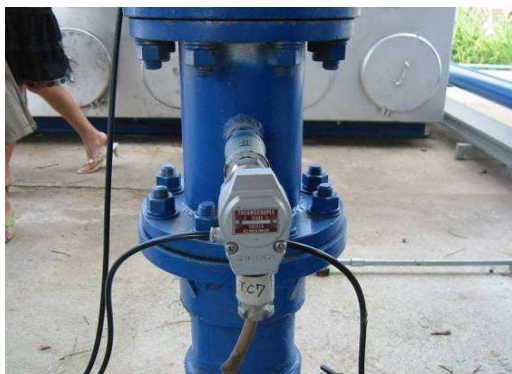
ก. Thermocouple Type K (ใช้วัด T_0 , T_1 - T_6 , T_g )
