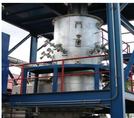
ก. เตาผลิตแก๊สเชื้อเพลิง (Downdraft Gasifier)
