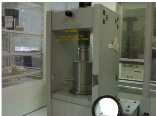
จ. เครื่องเตรียมตัวอย่างกากตะกอน สำหรับนำไปวิเคราะห์กับเครื่อง EDXRF
