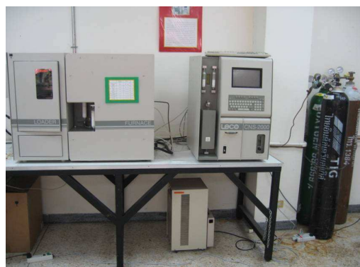
ง. เครื่อง CHNS Elemental Analyzer (วิเคราะห์ปริมาณธาตุ C H N S)
