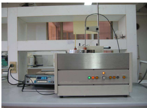
ค. เครื่อง Bomb Calorimeter (วิเคราะห์ค่าความร้อน)
