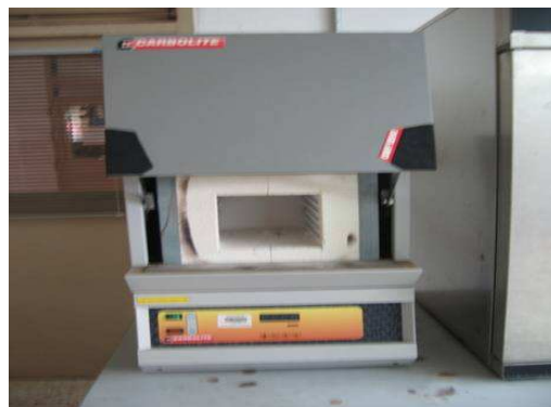
ข. เตาเผา Muffle Furnace (วิเคราะห์ปริมาณเถ้า และสารระเหย)
