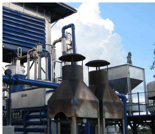
ซ. ชุดทดสอบการลุกไหม้ (Start Up Flare)
