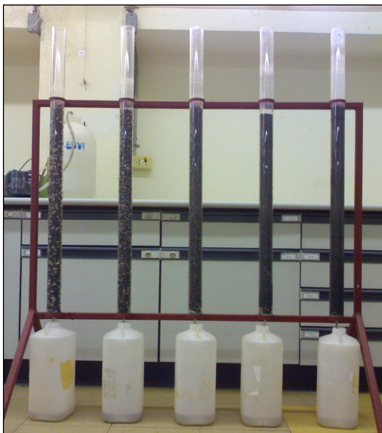
รูปที่ 3.3 ชุดคอลัมน์การเข้าสู่สมดุลการดูดซับที่ใช้ในการทดลอง
