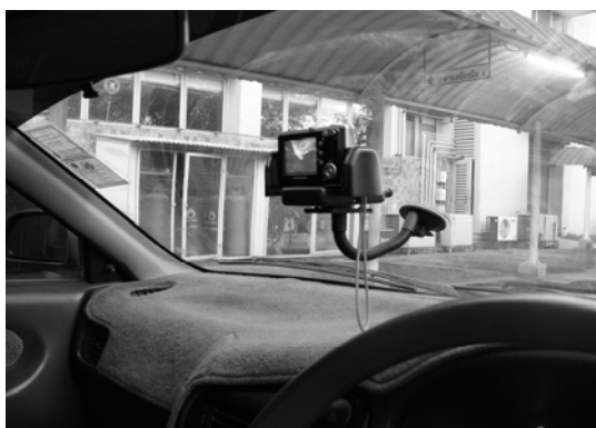
รูปที่ 4.2 ตำแหน่งติดตั้งกล้องภายในรถยนต์
