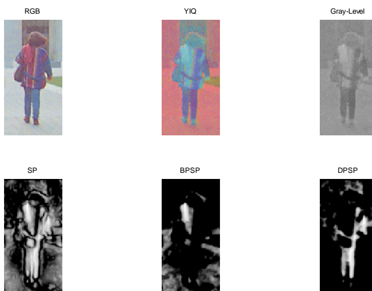
รูปที่ 3.29 ตัวอย่างภาพเฟสสมมาตร (SP) เฟสสมมาตรจุดสว่าง (BPSP) เฟสสมมาตรจุดมืด (DPSP) จากภาพระดับเทา (gray-level) จากมิติสี YIQ
