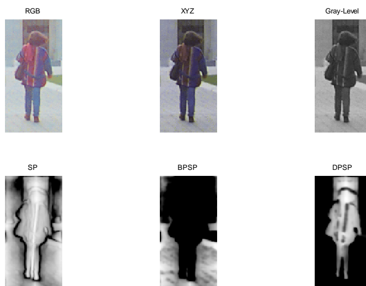
รูปที่ 3.33 ตัวอย่างภาพเฟสสมมาตร (SP) เฟสสมมาตรจุดสว่าง (BPSP) เฟสสมมาตรจุดมืด (DPSP) จากภาพระดับเทา (gray-level) จากมิติสี XYZ
