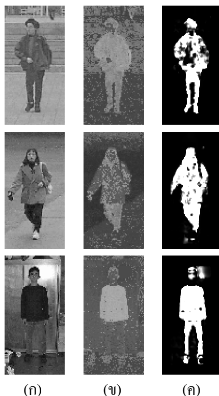
รูปที่ 5.11 ตัวอย่างผลภาพการดึงลักษณะเด่นคนเดินถนน (ก) ภาพคนเดินถนน (ข) ภาพมิติสี่ร่วม Hab และ (ค) ภาพเฟสสมมาตรมิติสี่ร่วม HabSP
