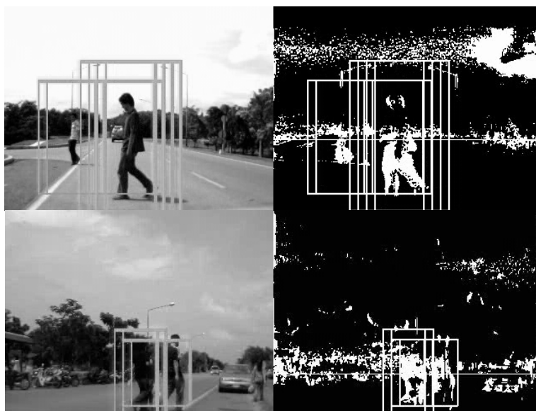
รูปที่ 5.18 ตัวอย่างผลการตรวจจับภาพคนเดินถนนด้วยเฟสอสมเมตริส (ซ้าย) ภาพบริเวณถนน (ขวา) ภาพเฟสอสมเมตริส
