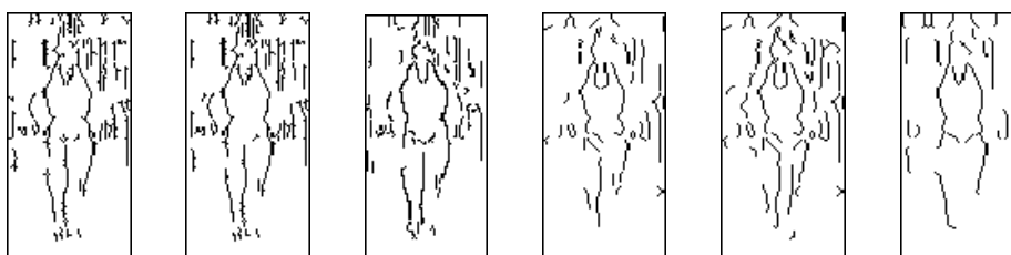
รูปที่ 3.2 ตัวอย่างการหาเส้นขอบแนวตั้งของภาพคนเดินถนนด้วยวิธีการต่าง ๆ ได้แก่ SB PW RB LOG ZC และ CN เรียงตามลำดับจากซ้ายไปขวา
