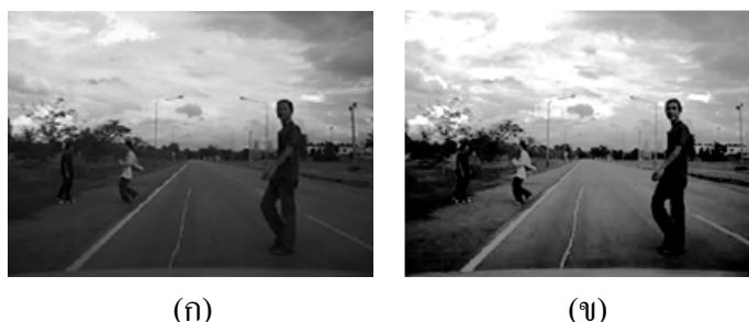
รูปที่ 4.4 ตัวอย่างภาพในการประมวลผลก่อน (ก) ภาพระดับเทาจากมิตีสี RGB และ (ข) ภาพระดับเทาที่ผ่านการปรับสมมูลฮิสโทแกรม
