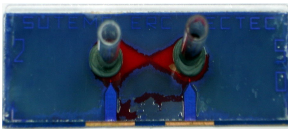
รูปที่ 4.10 บอนด์ที่อุณหภูมิ 100^{\circ}\text{C} นาน 60 นาที น้ำหมึกสีแดงสามารถซึมออกด้านข้างได้
