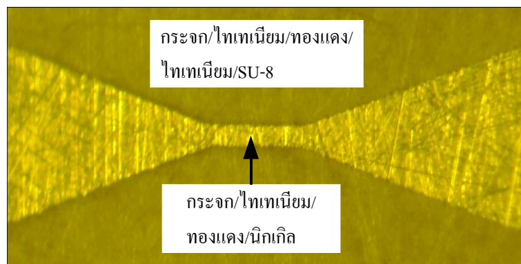
รูปที่ 4.45 ภาพชิ้นงานที่ขัดด้วยกระดาษทรายเบอร์ 1,200
