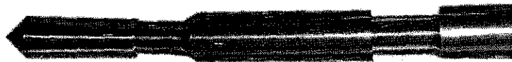
รูปที่ 1.23 ภาพถ่ายอุปกรณ์ทะลุทะลวงด้วยกรวย (Cone penetration)
