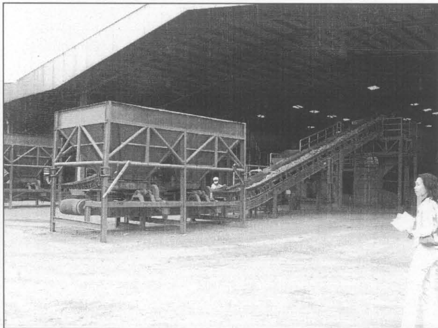
รูปที่ 5.6 แสดงการลำเลียงมันสำปะหลังผ่านสายพานลำเลียงไปสู่เครื่องร่อนดินทราย (ที่มา : บริษัทสงวนวงษ์ อุตสาหกรรมจำกัด)
