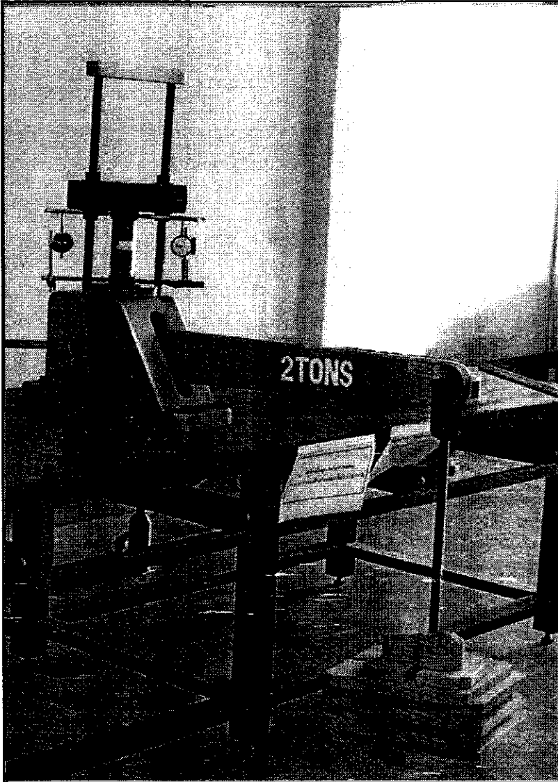
รูปที่ 4.11 การทดสอบการเคลื่อนไหลดินแกนเดี่ยว แท่งตัวอย่างเกลือหินอยู่ภายใต้เครื่องกด ที่ให้แรงกดคงที่ในแนวแกน
