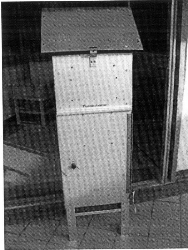
รูปที่ 1 เครื่องเก็บตัวอย่างฝุ่นละอองในบรรยากาศ Hi-vol ของห้องปฏิบัติการอนามัย สิ่งแวดล้อม (F8)
