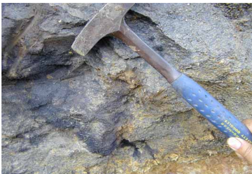
รูปที่ ก.9 บริเวณพื้นที่ที่มีการแทรกตัวของน้ำมันดิบสู่พื้นผิว
