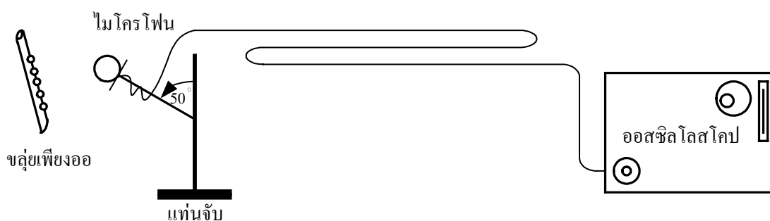
รูปที่ 4.1 การจัดวางอุปกรณ์บันทึกเสียงขลุ่ยเพียงออ
