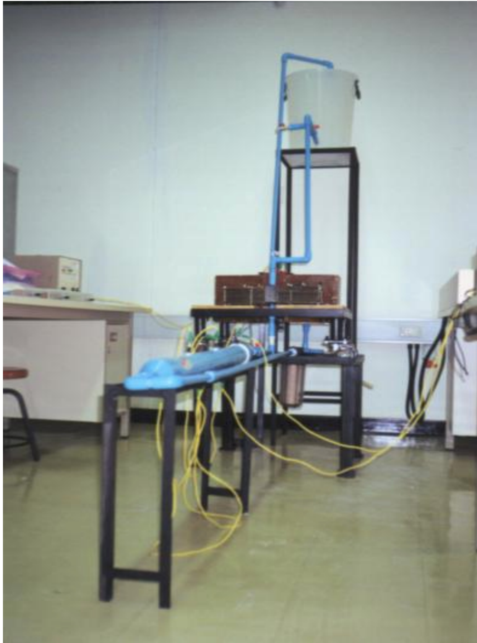
รูปที่ 3-4. แบบจำลองการใช้น้ำระดับห้องปฏิบัติการ
