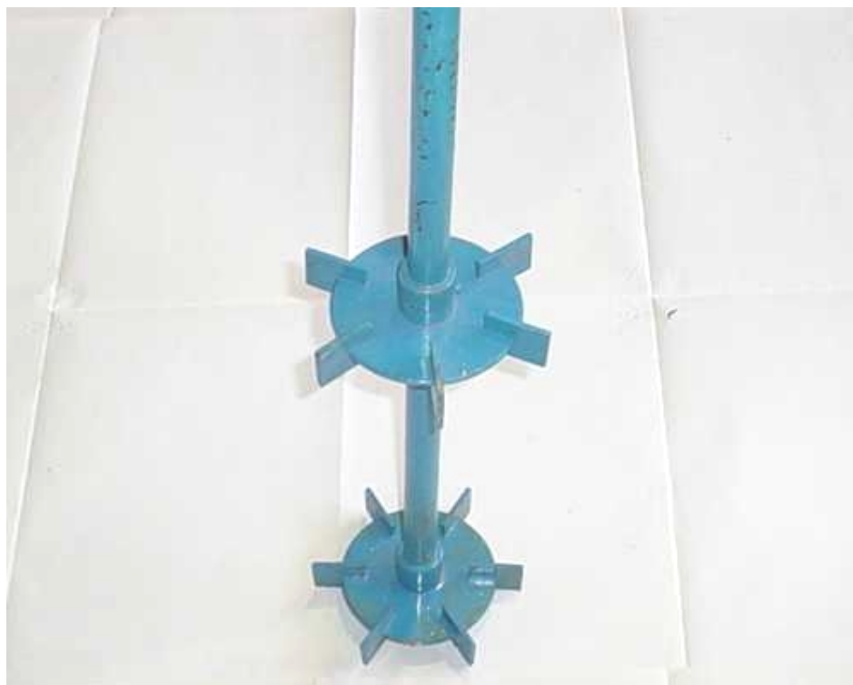
รูปที่ ช3 ใบพัดรัศมีทอนเทอร์ไบน์ 2 ชั้น
