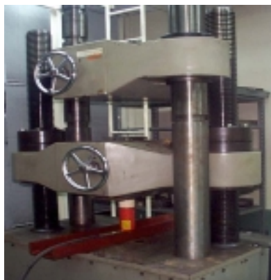
รูปที่ 3.2 เครื่อง UTM ยี่ห้อ SHIMADZU รุ่น UH-Series มีค่ากำลังทดสอบสูงสุด 200 ตัน
