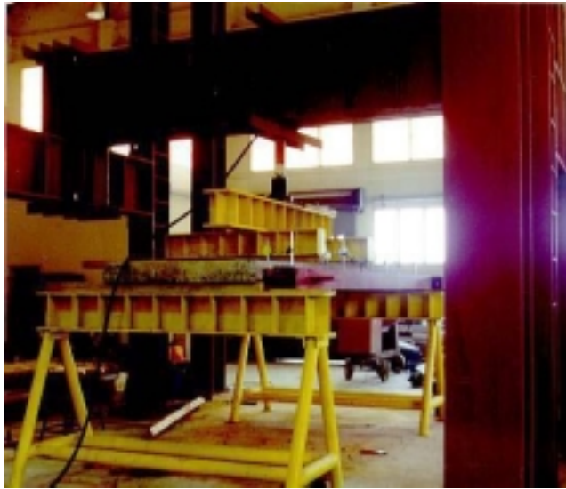
รูปที่ 3.11 อุปกรณ์การกดที่ติดตั้งอยู่กับเครื่องมือกด compression frame machine
