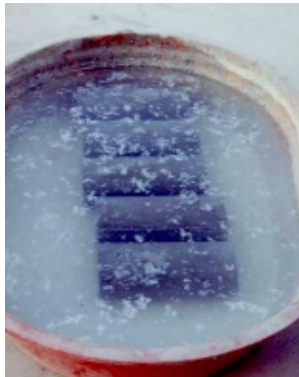
รูปที่ 3.10 ตัวอย่างคอนกรีตทับหน้าที่บ่มโดยการแช่ในน้ำปูนขาวอิ่มตัว
