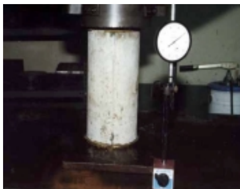
รูปที่ 3.3 การติดตั้งตัวอย่างคอนกรีต เพื่อทำการทดสอบกำลังอัดและวัดระยะการหดตัว
