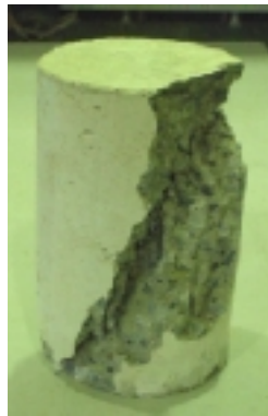
รูปที่ 4.2 คอนกรีตที่เกิดการวิบัติ เมื่อได้รับแรงกดอัด
