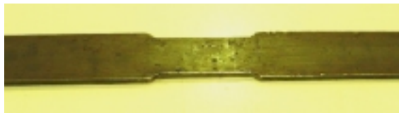
รูปที่ 3.4 ตัวอย่างแผ่นเหล็กรูปกระดูก ตามมาตรฐาน ASTM A36-1996
