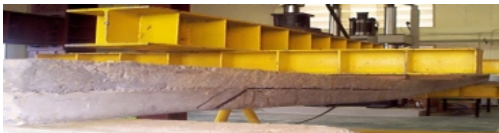
รูปที่ 4.20 พื้นคอนกรีตอัดแรงสำเร็จรูปที่วิบัติโดยแรงเฉือนขวางที่ปลายของแผ่นเหล็ก
