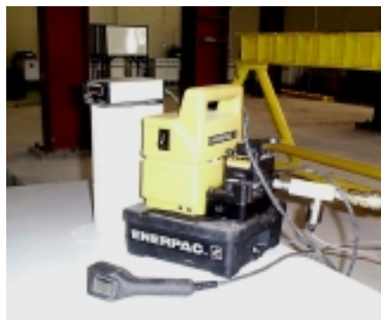
รูปที่ 3.12 ดิจิตอลวัดความดันละเอียดยี่ห้อ ENERPAC รุ่น Model DGP/10,000 psi และเครื่องสูบลไฮดรอลิก ยี่ห้อ ENERPAC รุ่น Model No. PUJ1400E
