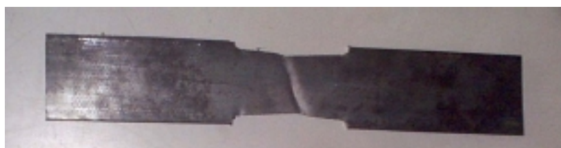
รูปที่ 4.5 แผ่นเหล็กที่เกิดการวิบัติ เมื่อได้รับแรงดึง
