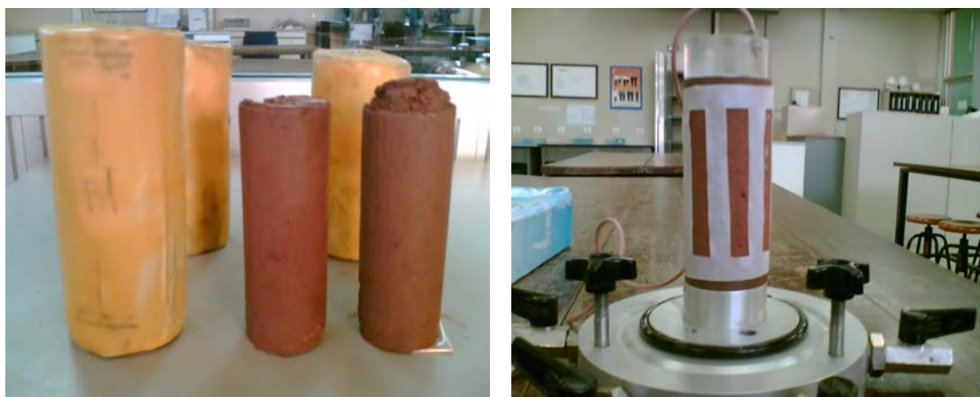
รูปที่ 3.3 ตัวอย่างคงสภาพที่ถูกเตรียมสำหรับการทดสอบแรงอัดสามแกน
