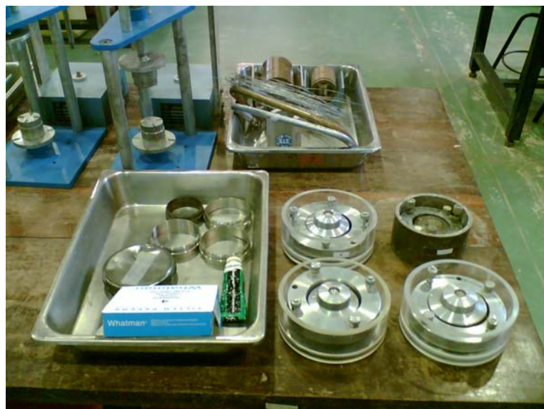
รูปที่ 3.4 เครื่องมือทดสอบการทรุดตัวของดิน (consolidometer หรือ oedometer)
