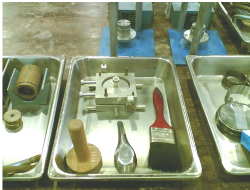
รูปที่ 3.5 เครื่องมือทดสอบแรงเฉือนตรง (direct shear test)
