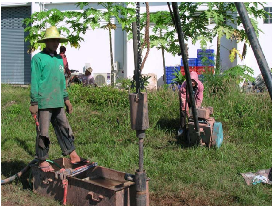
รูปที่ 3.7 การเจาะสำรวจและการทดสอบทะลุทะลวงมาตรฐาน
