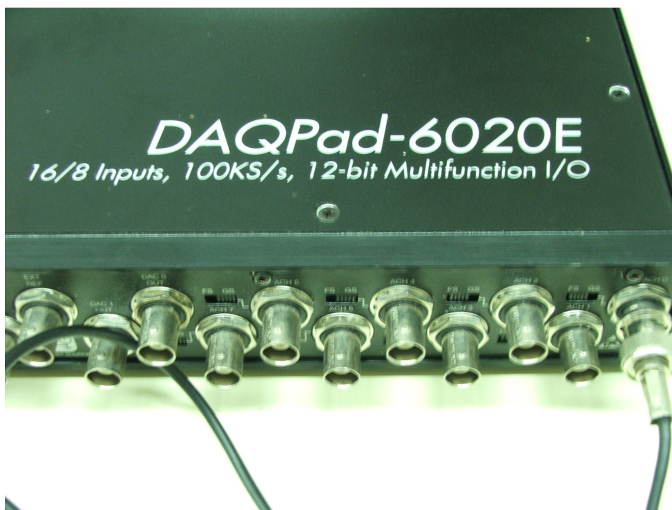
รูปที่ ค.6 ตัวลงบันทึกข้อมูล (data logger) โดยจะบันทึกค่าไปเก็บในคอมพิวเตอร์ทุกๆ 1 ms
