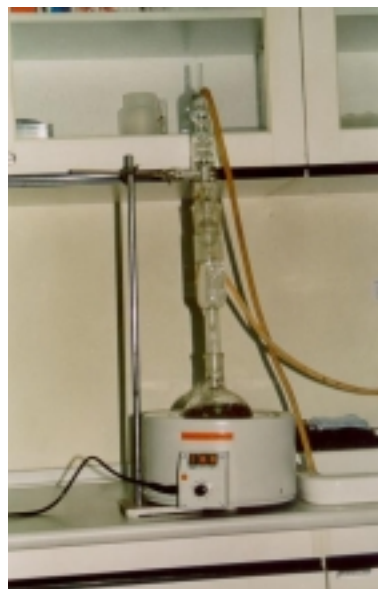
ภาพที่ 2.1 เครื่องมือสกัด Soxhlet extraction apparatus
