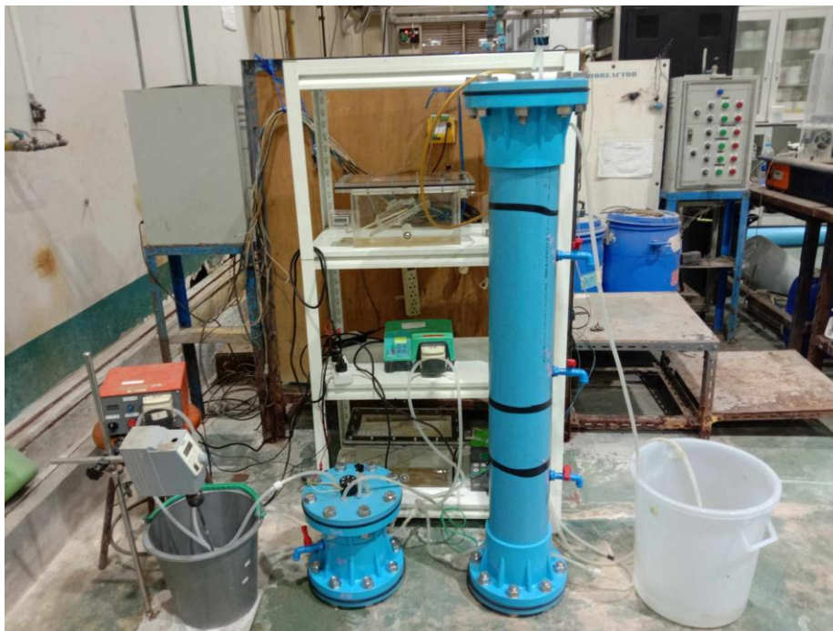
รูปที่ 3.8 การติดตั้งชุดทดลองระบบ Two-stage CSTR
