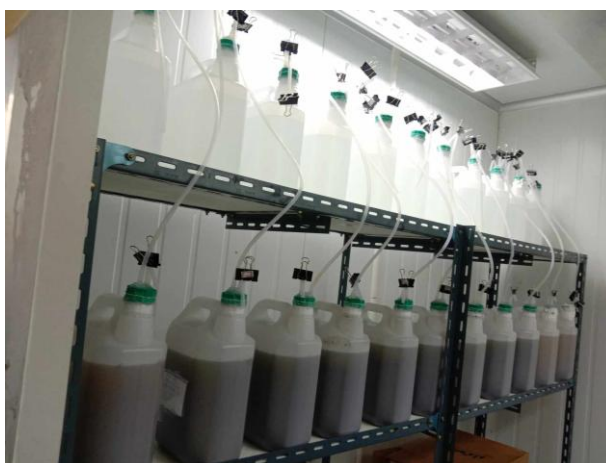
รูปที่ ก.2 ชุดทดลอง BMP Test
