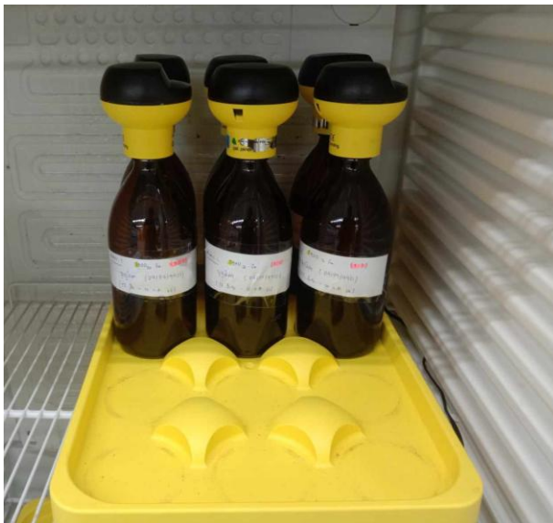
รูปที่ ก.1 การวิเคราะห์ BOD 20 โดยเครื่อง Oxitop
