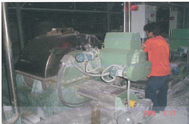
ภาพที่ ก - 11 เครื่องสัด เพื่อสัดน้ำที่มีอยู่ในน้ำแป้งออก
