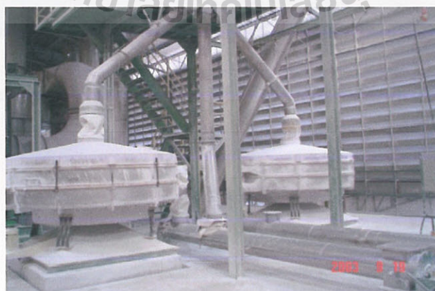
ภาพที่ ก - 13 เครื่องร่อนแป้ง เพื่อคัดขนาดของแป้ง
