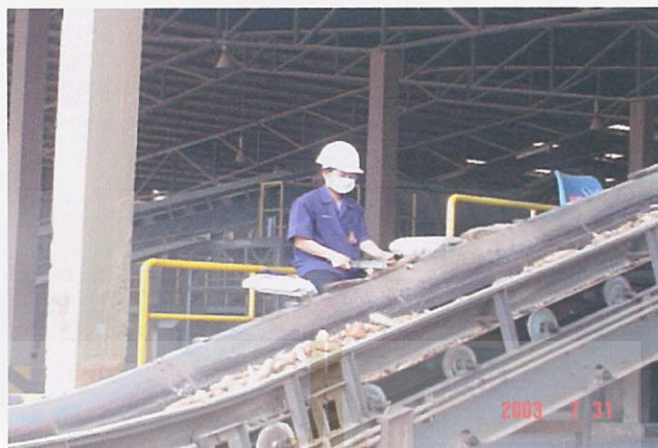
ภาพที่ ก - 5 พนักงานสับเหง้ามันก่อนขึ้นตะแกรงร่อนเปลือก
