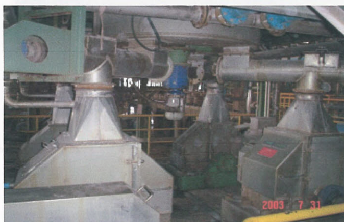
ภาพที่ ก - 7 ชุดเครื่องบดและโม้ เพื่อลดขนาดหัวมันสำปะหลังให้ละเอียด
