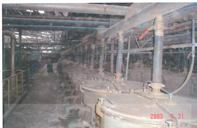
ภาพที่ ก - 8 ชุดเครื่องสกัดแป้ง ( Extractor ) เพื่อแยกน้ำแป้งออกจากมัน
