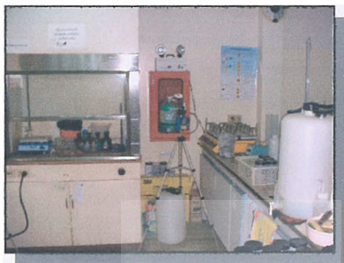
เครื่องดูดอากาศบริเวณการทำงาน
