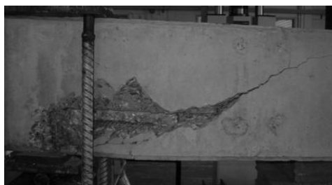
รูปที่ 4.17 รูปการวิบัติจริงของคานกลุ่มที่ (2) และกลุ่มที่ (3) ที่มีระยะฝังเหล็กทรงน้ำ 500 mm
