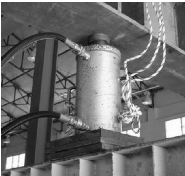
รูปที่ 3.7 Hydraulic ram กำลังทดสอบสูงสุด 500 kN
