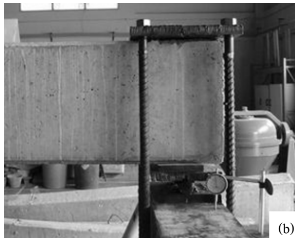
รูปที่ 3.24 การติดตั้ง dial gauge (a) วัดค่าการแอ่นตัวของคาน (b) วัดค่าการทรุดตัวสัมพัทธ์ระหว่างตัวอย่างทดสอบและจุดรองรับ
