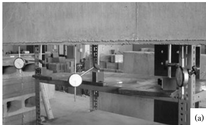
รูปที่ 3.23 แผนภาพการติดตั้ง dial gauge เพื่อวัดค่าการแอ่นตัวของตัวอย่างทดสอบคาน
