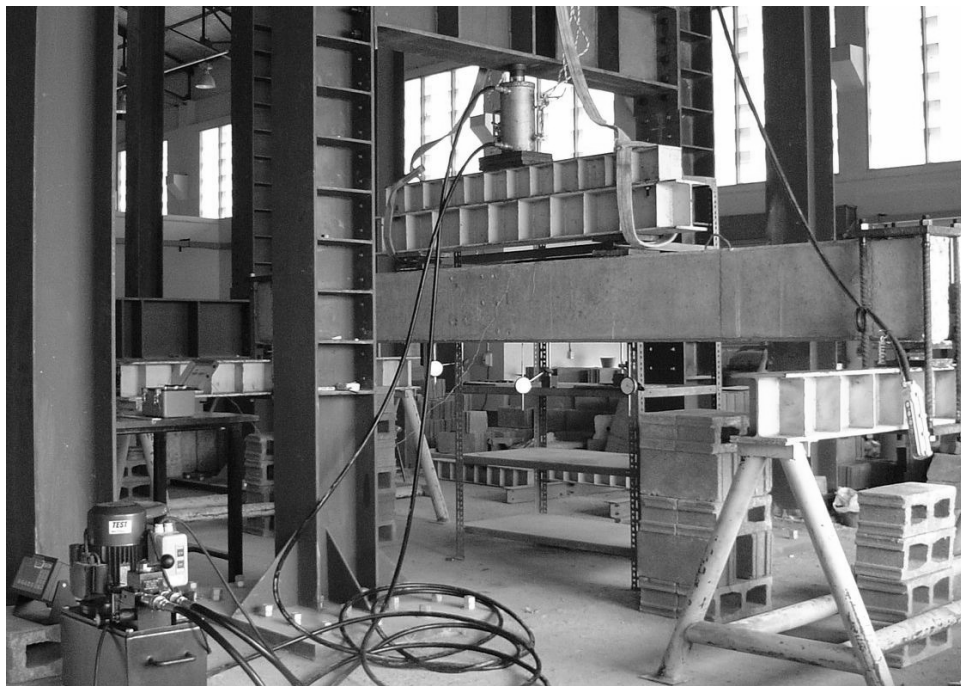
รูปที่ 3.22 การติดตั้งเครื่องมือที่ใช้ทดสอบแรงค้ำของคาน
