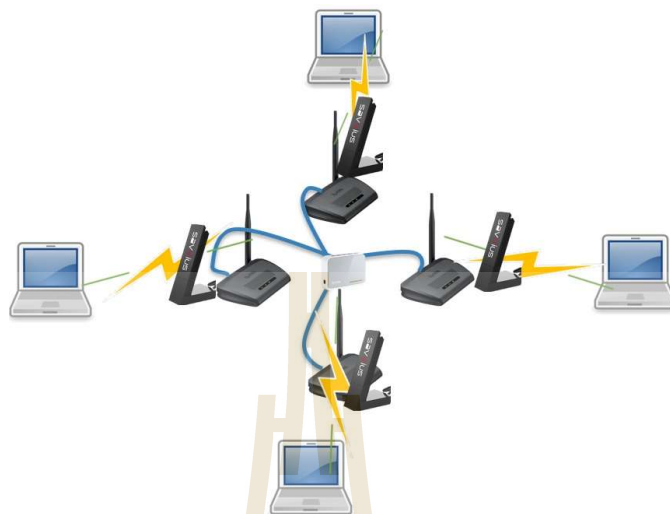
รูปที่ 4.5 รูปแบบโนดรูปแบบที่ 2 ใช้สายอากาศรอบตัว 4 ตัว
