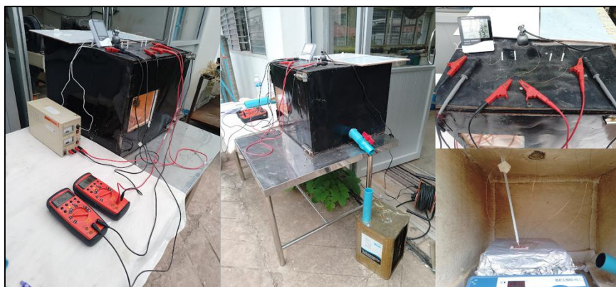
รูปที่ 3.11 อุปกรณ์สำหรับวัดค่าการเปลี่ยนแปลงสภาพต้านทานไฟฟ้า โดยวิธีการ 4-Point method
