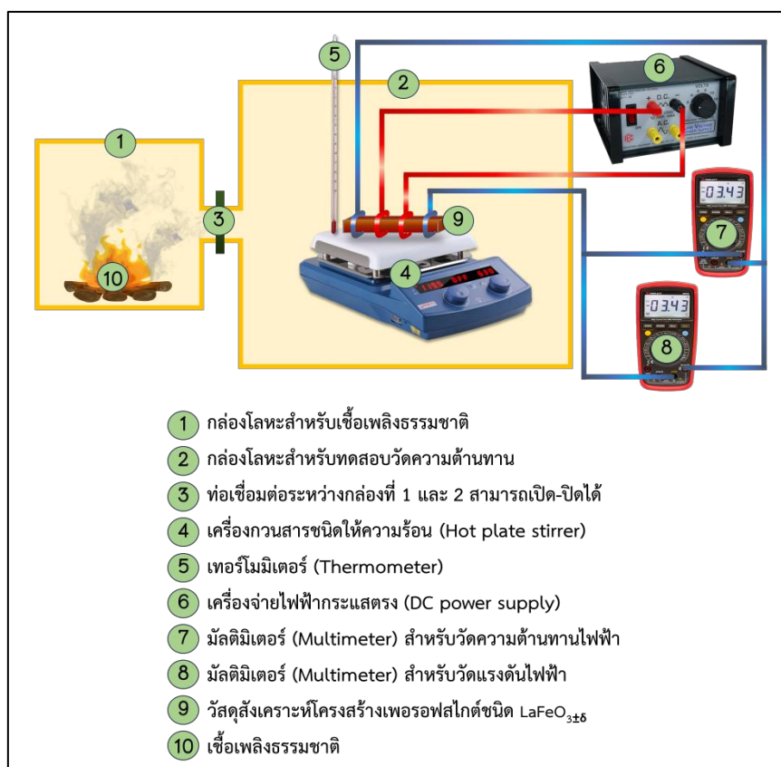
รูปที่ 3.12 ส่วนประกอบและการต่อวงจรไฟฟ้า เพื่อใช้วัดประสิทธิภาพในการตรวจจับแก๊ส โดยเทคนิค 4-point method
