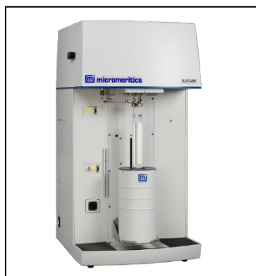
รูปที่ 3.10 Brunauer-Emmett-Teller method ผู้ผลิต Micromeritics รุ่น 3Flex (ที่มา: https://analytical.sut.ac.th/eq_page.php?id=3002 )
