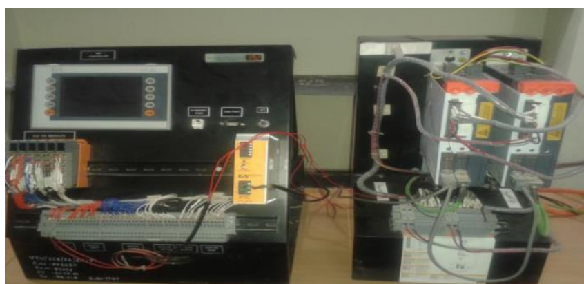
รูปที่ 2.34 การตั้งค่าฮาร์ดแวร์ PLC B&R
