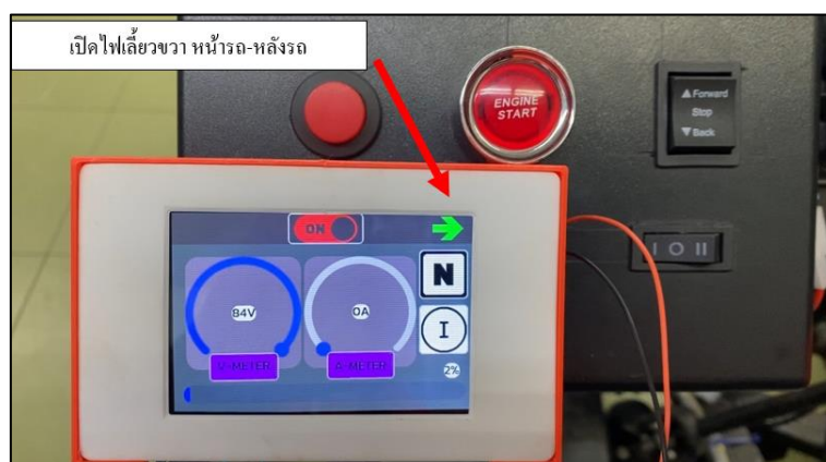
รูปที่ 4.9 สภาวะเปิดไฟเลี้ยวขวา (หน้ารถและหลังรถ ทำงานพร้อมกัน)
