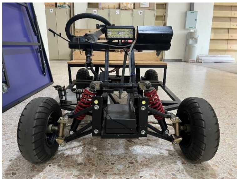
รูปที่ 4.18 โมดูล CAN I/O PLC ที่ 2 และหลอดไฟเลี้ยวด้านหน้า
