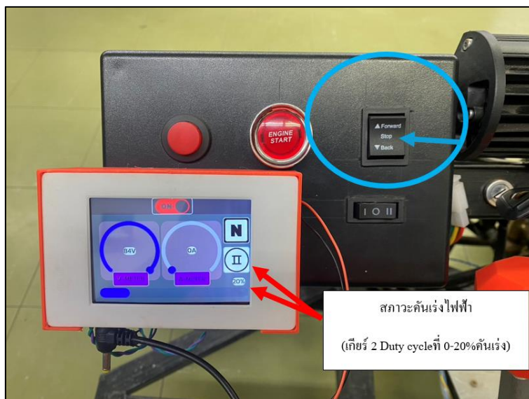
รูปที่ 4.14 สภาวะกดเกียร์ว่างในโหมด Normal โดยสภาวะคันเร่งไฟฟ้าอยู่ที่ 0-20%
