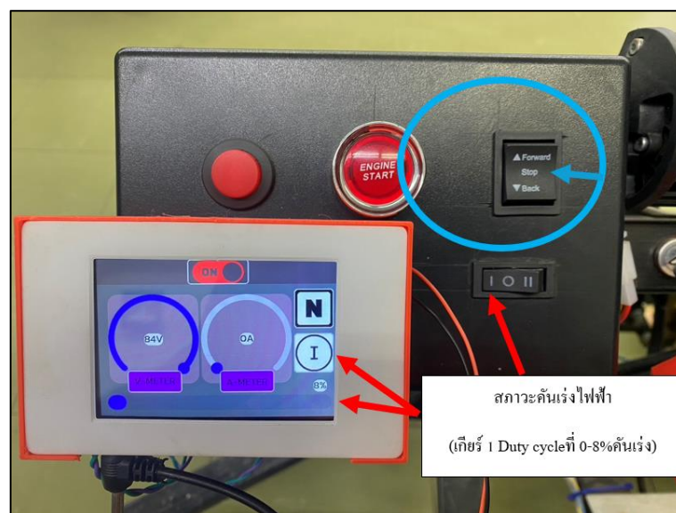
รูปที่ 4.13 สภาวะกดยกเกียร์ว่างในโหมด Eco โดยสภาวะคันเร่งไฟฟ้าอยู่ที่ 0-8%
