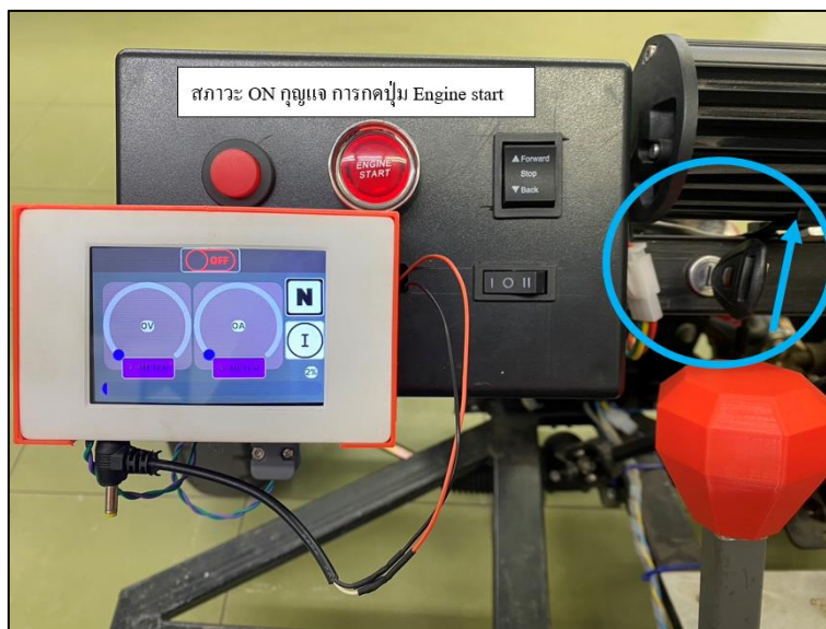
รูปที่ 4.6 สภาวะเปิดกุญแจอยู่ในสถานะ ON มีการกดปุ่ม Engine start
