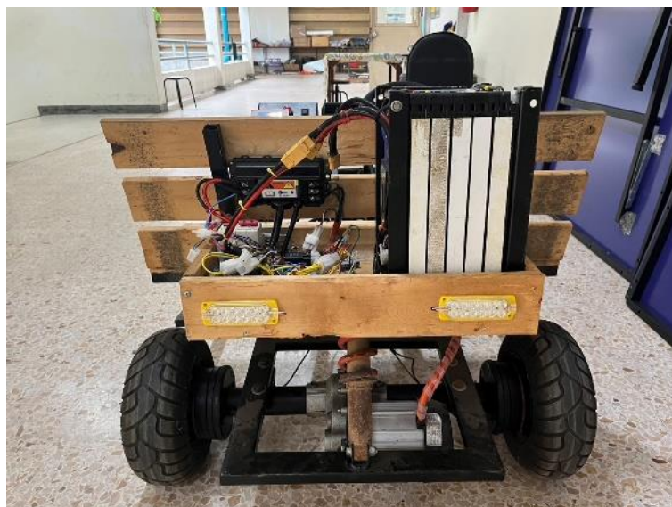
รูปที่ 4.19 โมดูล CAN I/O PLC ที่ 3 และหลอดไฟเลี้ยวด้านหลัง
