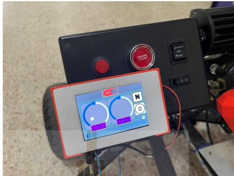
รูปที่ 4.17 โมดูล CAN I/O PLC ที่ 1 และหน้าจอแสดงผล
