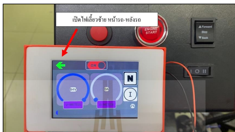
รูปที่ 4.8 สภาวะเปิดไฟเลี้ยวซ้าย (หน้ารถและหลังรถ ทำงานพร้อมกัน)
