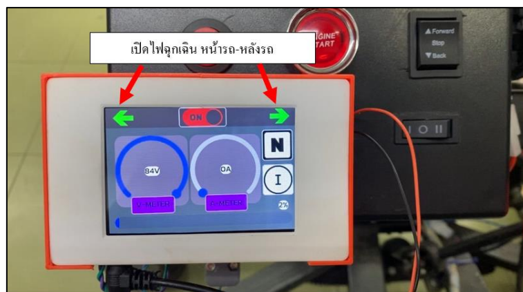
รูปที่ 4.10 สภาวะเปิดไฟฉุกเฉิน (หน้ารถและหลังรถ ทำงานพร้อมกัน)
