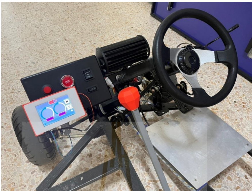
รูปที่ 6.3 ชุดควบคุมด้านหน้ารถ ATV
