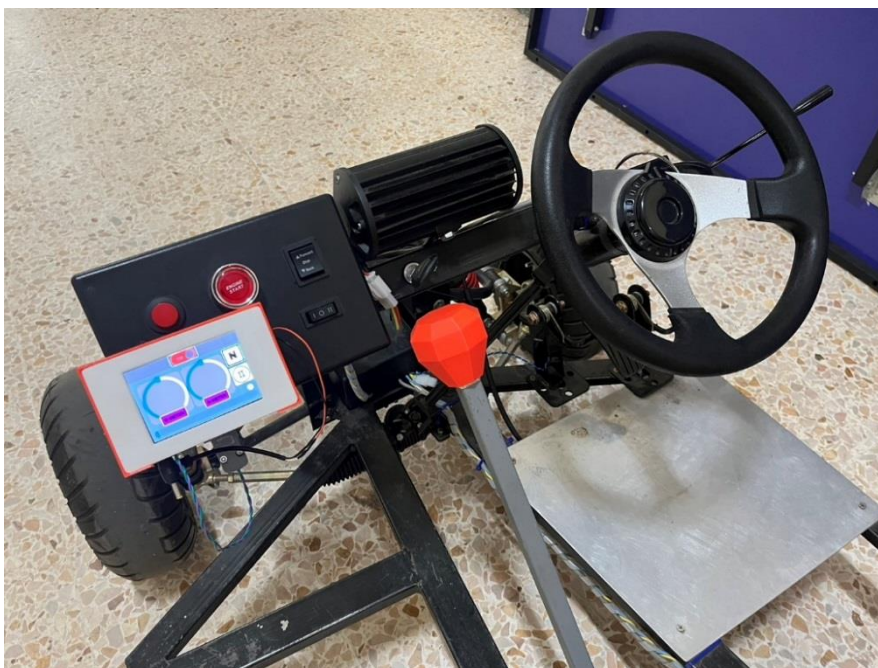
รูปที่ 6.3 ชุดควบคุมด้านหน้ารถ ATV
