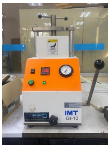
รูปที่ 3.6 เครื่องอัดขึ้นเรือนโลหะวิทยาแบบร้อน ยี่ห้อ IMT รุ่น G1-10
