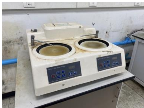
รูปที่ 3.8 เครื่องขัดผงอะลูมินา
