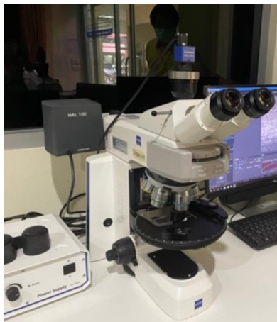
รูปที่ 3.10 กล้องจุลทรรศน์แบบใช้แสง
