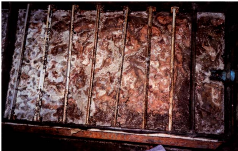
ภาพที่ 3.4 บ่อแอนแอโรบิกแบบติดผิวที่ใช้ในการทดลอง
