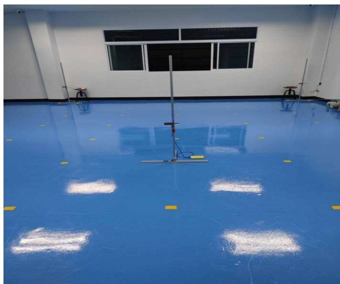
รูปที่ 4.3 ระบุตำแหน่งเซ็นเซอร์ ESP32 UWB DW1000
