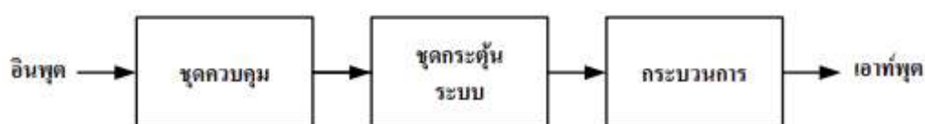
รูปที่ 2.12 บล็อกไดอะแกรมของระบบควบคุมแบบเปิด
