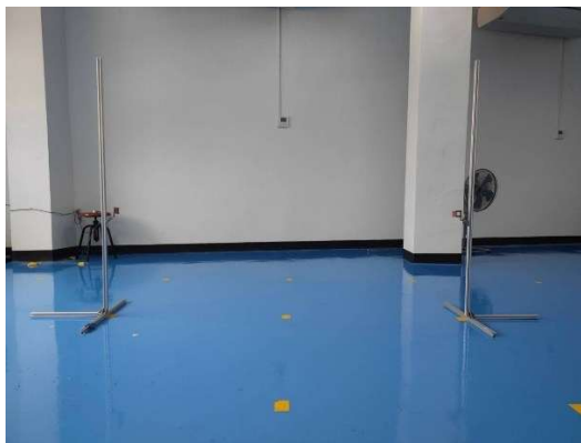
รูปที่ 4.1 การวัดเซ็นเซอร์ ESP32 UWB DW1000 ระหว่างจุด
