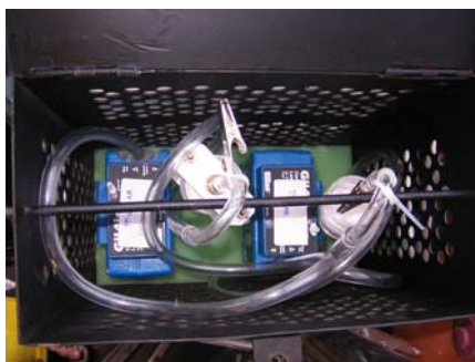
รูปที่ 3.3 การติดตั้งเครื่องมือเก็บตัวอย่างอากาศในกล่องโลหะ
