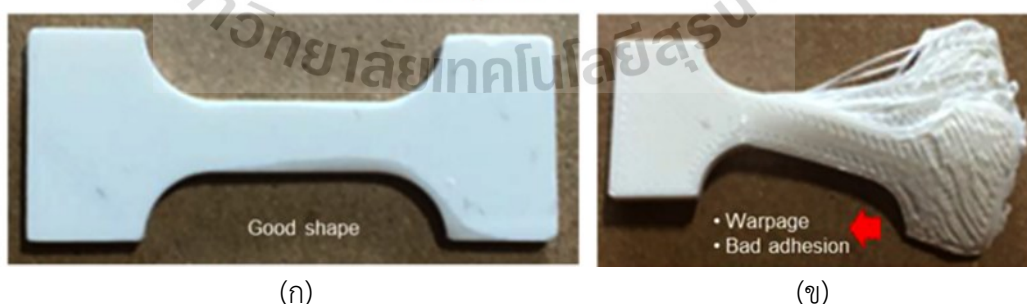
รูปที่ 2.2 ภาพถ่ายของชิ้นงานที่พิมพ์โดยเครื่องพิมพ์ 3 มิติ: (ก) สถานะปกติ และ (ข) สถานะผิดพลาด
