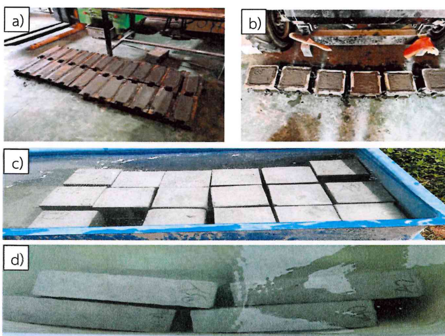
รูปที่ 3-5 a) , b) ทิ้งคอนกรีต 24 ชั่วโมง ทำการแกะแบบคอนกรีตและ c) , d) บ่มคอนกรีต (CONCRETE CURING) จำนวน 7, 28 และ 60 วัน
