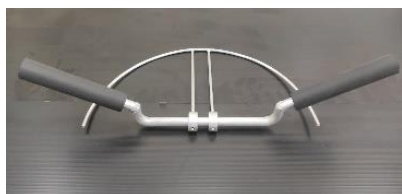
ภาพที่ 3.8 อุปกรณ์จำลองถุงกระสอบที่มีมือจับ
