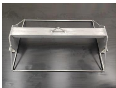
ภาพที่ 3.10 อุปกรณ์จำลองตะกร้าพลาสติก
