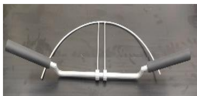
ภาพที่ 3.8 อุปกรณ์จำลองถุงกระสอบที่มีมือจับ
