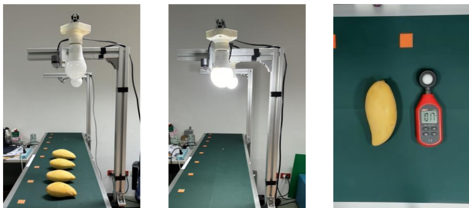
รูปที่ 3.3 ชุดสายพานทดสอบและอุปกรณ์วัดความสว่าง (ลักซ์มิเตอร์)
