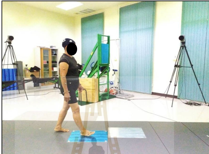
รูปที่ 6.3 อาสาสมัครเดินผ่านแผ่นวัดแรงถูกบันทึกผ่านกล้องอินฟราเรด
