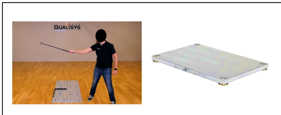
รูปที่ 3.2 การสอบเทียบด้วยกล้องไม้ตัวที่ (ซ้าย) และแผ่นรับแรง (ขวา)
