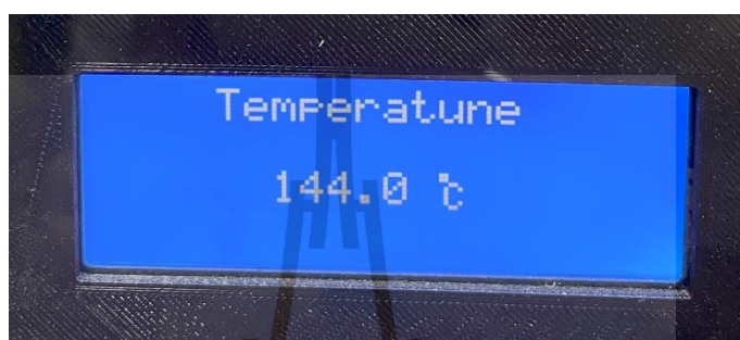
รูปที่ 4.75 แสดงอุณหภูมิรวมภายในท่อลำเลียงข้าวสารที่กำลังงานรวม 4,116W ได้อุณหภูมิ 144 องศาเซลเซียส
