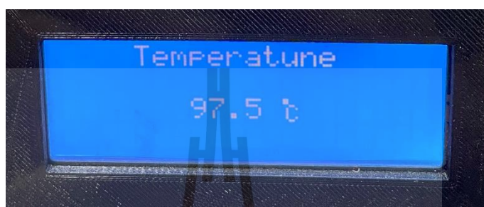
รูปที่ 4.31 แสดงอุณหภูมิรวมภายในท่อลำเลียงข้าวสารที่กำลังงานรวม 2,580W ได้อุณหภูมิ 97.5 องศาเซลเซียส
