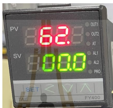
รูปที่ 4.17 แสดงอุณหภูมิของระบบการเป่าลมร้อนที่กำลังงาน 2,352W ได้อุณหภูมิ 62 องศาเซลเซียส
