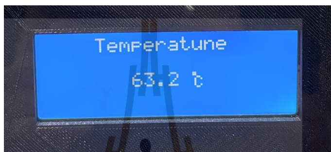
รูปที่ 4.23 แสดงอุณหภูมิรวมภายในท่อลำเลียงข้าวสารที่กำลังงานรวม 1,289W ได้อุณหภูมิ 63.2 องศาเซลเซียส
