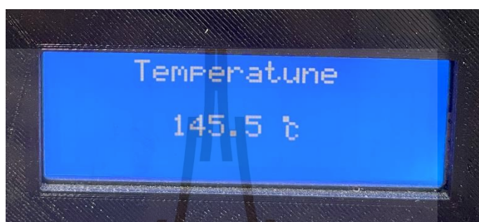
รูปที่ 4.57 แสดงอุณหภูมิรวมภายในท่อลำเลียงข้าวสารที่กำลังงานรวม 4,116W ได้อุณหภูมิ 145.5 องศาเซลเซียส
