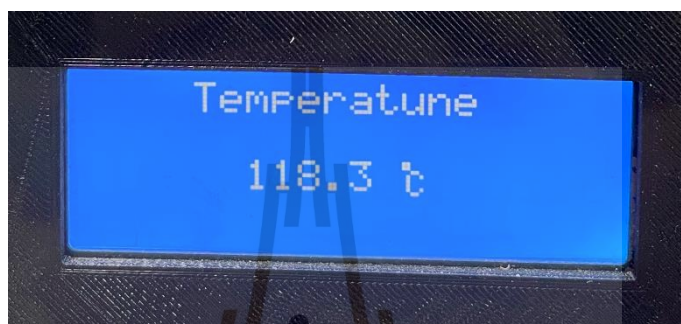
รูปที่ 4.69 แสดงอุณหภูมิรวมภายในท่อลำเลียงข้าวสารที่กำลังงานรวม 3,984W ได้อุณหภูมิ 118.3 องศาเซลเซียส
