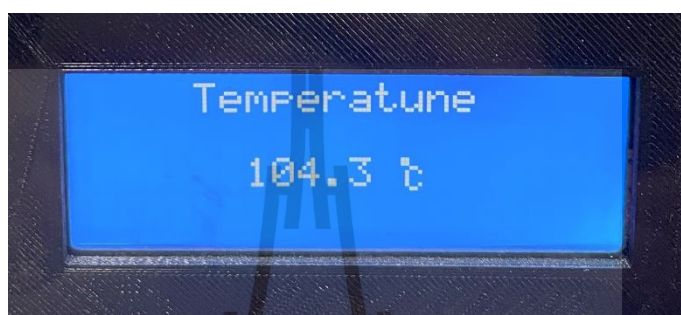
รูปที่ 4.63 แสดงอุณหภูมิรวมภายในท่อลำเลียงข้าวสารที่กำลังงานรวม 3,902W ได้อุณหภูมิ 104.3 องศาเซลเซียส
