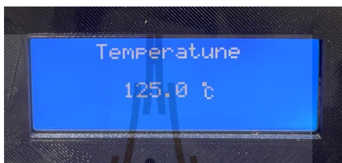
รูปที่ 4.55 แสดงอุณหภูมิรวมภายในท่อลำเลียงข้าวสารที่กำลังงานรวม 2,712W ได้อุณหภูมิ 125 องศาเซลเซียส
