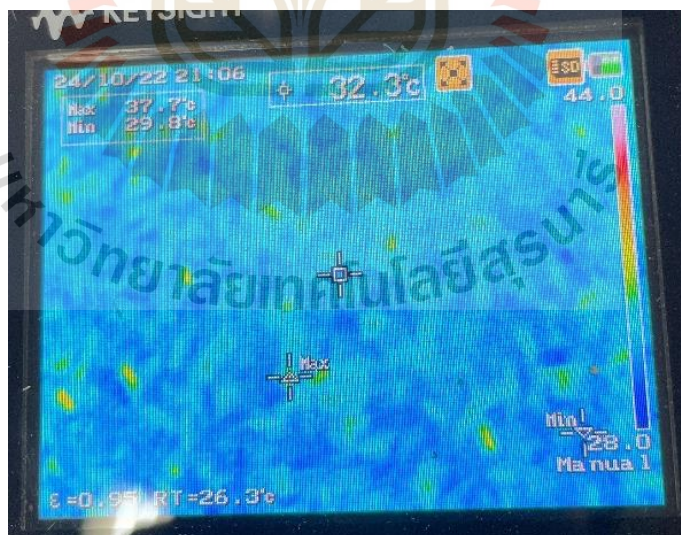
รูปที่ 4.24 แสดงอุณหภูมิของข้าวสารที่ผ่านการให้ความร้อนด้วยระบบการเหนี่ยวนำร่วมกับลมร้อนที่กำลังงาน 1,289W และที่อัตราการไหล 100kg/h
