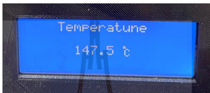
รูปที่ 4.39 แสดงอุณหภูมิรวมภายในท่อลำเลียงข้าวสารที่กำลังงานรวม 4,116W ได้อุณหภูมิ 147.5 องศาเซลเซียส
