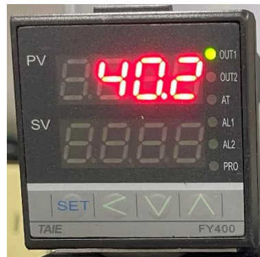
รูปที่ 4.3 แสดงอุณหภูมิของระบบการเป่าลมร้อนที่กำลังงาน 1,143W ได้อุณหภูมิ 40.2 องศาเซลเซียส
