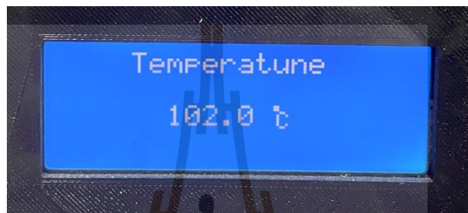
รูปที่ 4.35 แสดงอุณหภูมิรวมภายในท่อลำเลียงข้าวสารที่กำลังงานรวม 1,503W ได้อุณหภูมิ 102 องศาเซลเซียส
