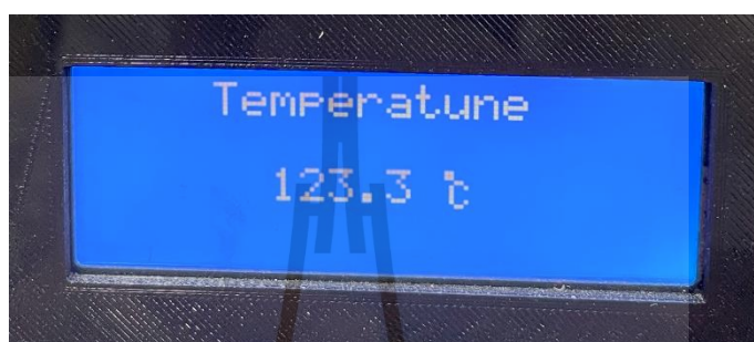
รูปที่ 4.73 แสดงอุณหภูมิรวมภายในท่อลำเลียงข้าวสารที่กำลังงานรวม 2,712W ได้อุณหภูมิ 123.3 องศาเซลเซียส
