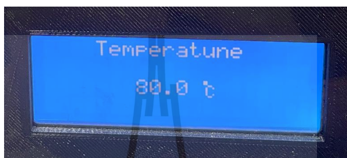
รูปที่ 4.61 แสดงอุณหภูมิรวมภายในท่อลำเลียงข้าวสารที่กำลังงานรวม 2,498W ได้อุณหภูมิ 80 องศาเซลเซียส
