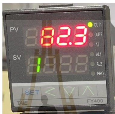
รูปที่ 4.19 แสดงอุณหภูมิของระบบการเป่าลมร้อนที่กำลังงาน 3,756W ได้อุณหภูมิ 82.3 องศาเซลเซียส
