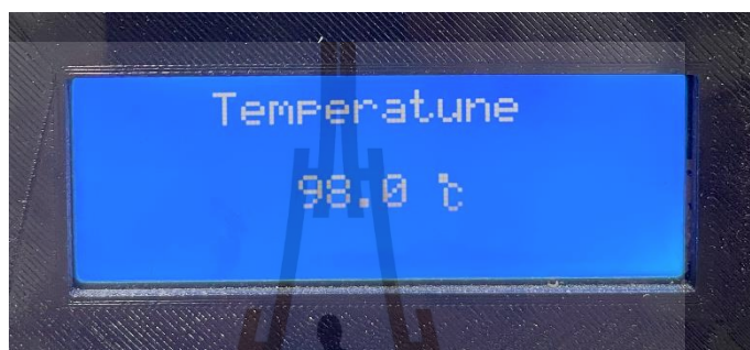
รูปที่ 4.71 แสดงอุณหภูมิรวมภายในท่อลำเลียงข้าวสารที่กำลังงานรวม 1,503W ได้อุณหภูมิ 98 องศาเซลเซียส
