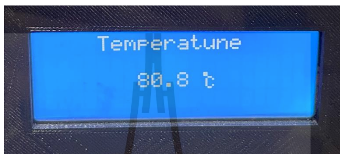
รูปที่ 4.43 แสดงอุณหภูมิรวมภายในท่อลำเลียงข้าวสารที่กำลังงานรวม 2,498W ได้อุณหภูมิ 80.8 องศาเซลเซียส
