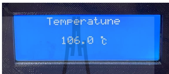
รูปที่ 4.45 แสดงอุณหภูมิรวมภายในท่อลำเลียงข้าวสารที่กำลังงานรวม 3,902W ได้อุณหภูมิ 106 องศาเซลเซียส
