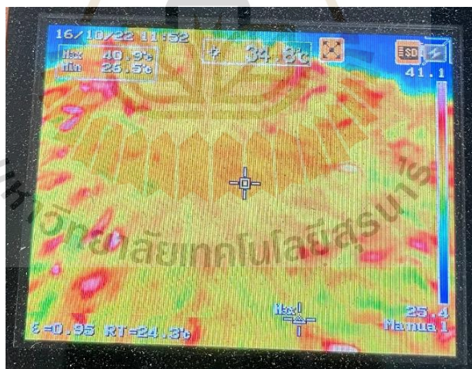
รูปที่ 4.32 แสดงอุณหภูมิของข้าวสารที่ผ่านการให้ความร้อนด้วยระบบการเหนี่ยวนำร่วมกับลมร้อนที่กำลังงาน 2,580W และที่อัตราการไหล 100kg/h
