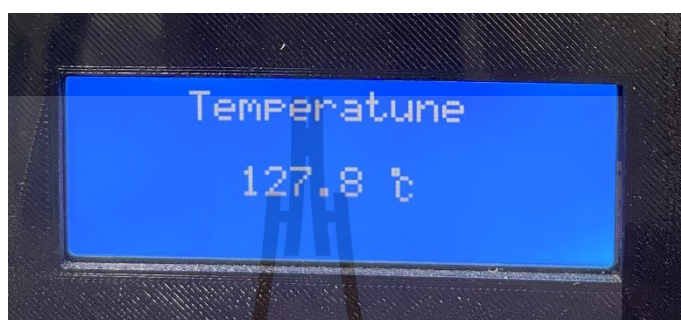
รูปที่ 4.37 แสดงอุณหภูมิรวมภายในท่อลำเลียงข้าวสารที่กำลังงานรวม 2,712W ได้อุณหภูมิ 127.8 องศาเซลเซียส
