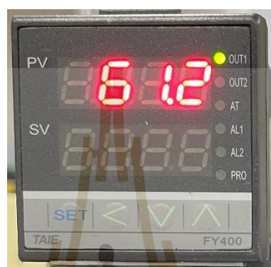
รูปที่ 4.5 แสดงอุณหภูมิของระบบการเป่าลมร้อนที่กำลังงาน 2,352W ได้อุณหภูมิ 61.2 องศาเซลเซียส
