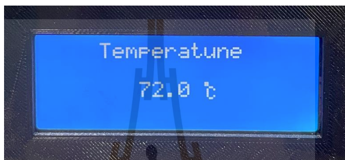
รูปที่ 4.47 แสดงอุณหภูมิรวมภายในท่อลำเลียงข้าวสารที่กำลังงานรวม 1,371W ได้อุณหภูมิ 72 องศาเซลเซียส
