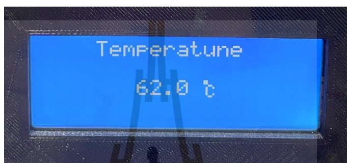
รูปที่ 4.59 แสดงอุณหภูมิรวมภายในท่อลำเลียงข้าวสารที่กำลังงานรวม 1,289W ได้อุณหภูมิ 62 องศาเซลเซียส
