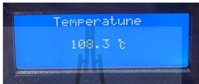
รูปที่ 4.27 แสดงอุณหภูมิรวมภายในท่อลำเลียงข้าวสารที่กำลังงานรวม 3,902W ได้อุณหภูมิ 108.3 องศาเซลเซียส
