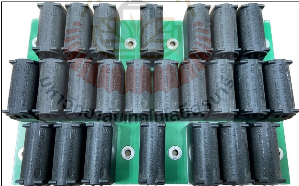
รูปที่ 3.10 วงจรขนาน Capacitor ที่ได้จากการออกแบบพร้อมใส่อุปกรณ์ (ด้านหน้า)
