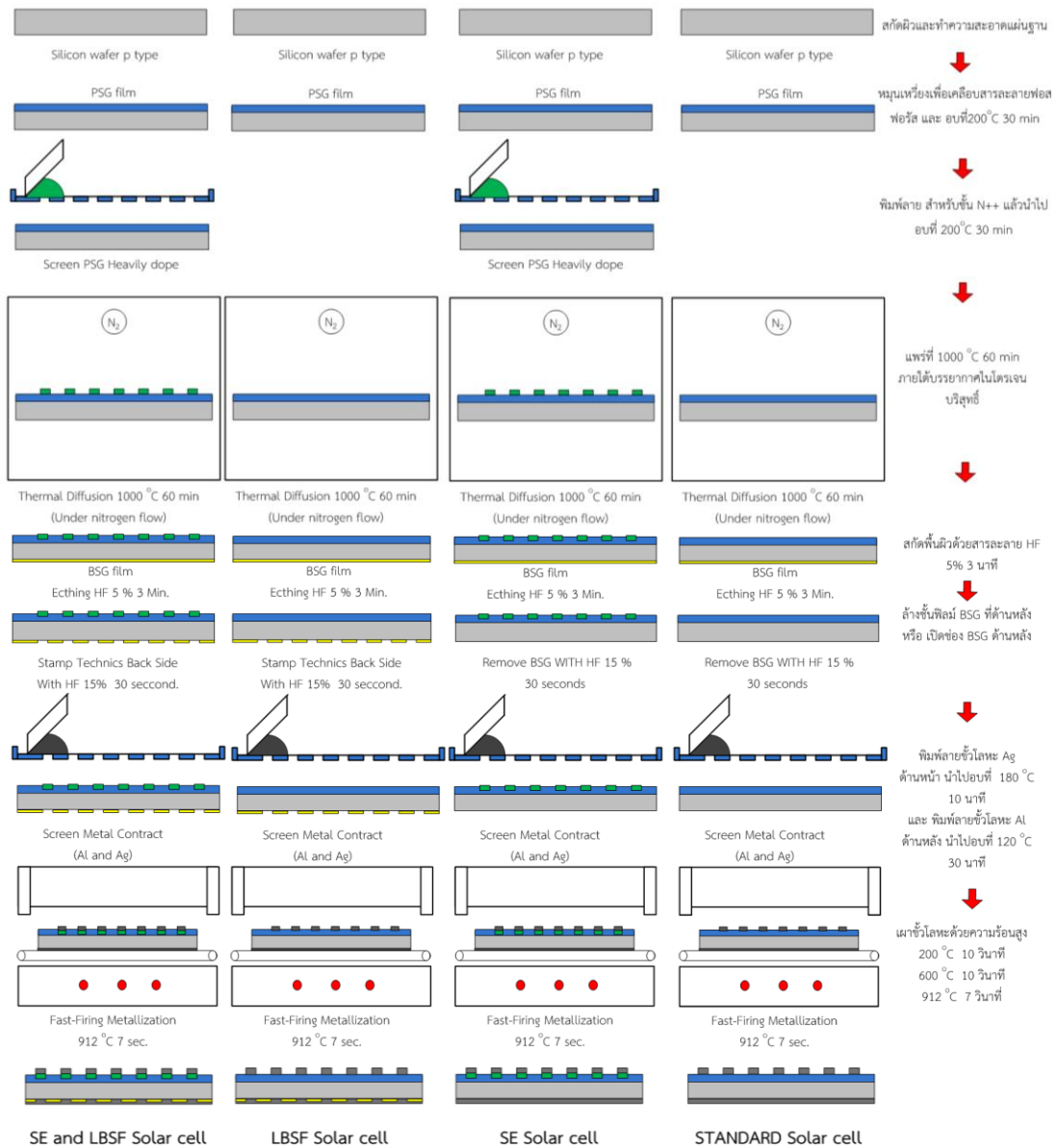
รูปที่ 3.19 ขั้นตอนการสร้างเซลล์แสงอาทิตย์โครงสร้างมาตรฐานเปรียบเทียบกับเซลล์แสงอาทิตย์โครงสร้าง SE เซลล์แสงอาทิตย์โครงสร้าง LBSF เซลล์แสงอาทิตย์โครงสร้าง SE and LBSF
