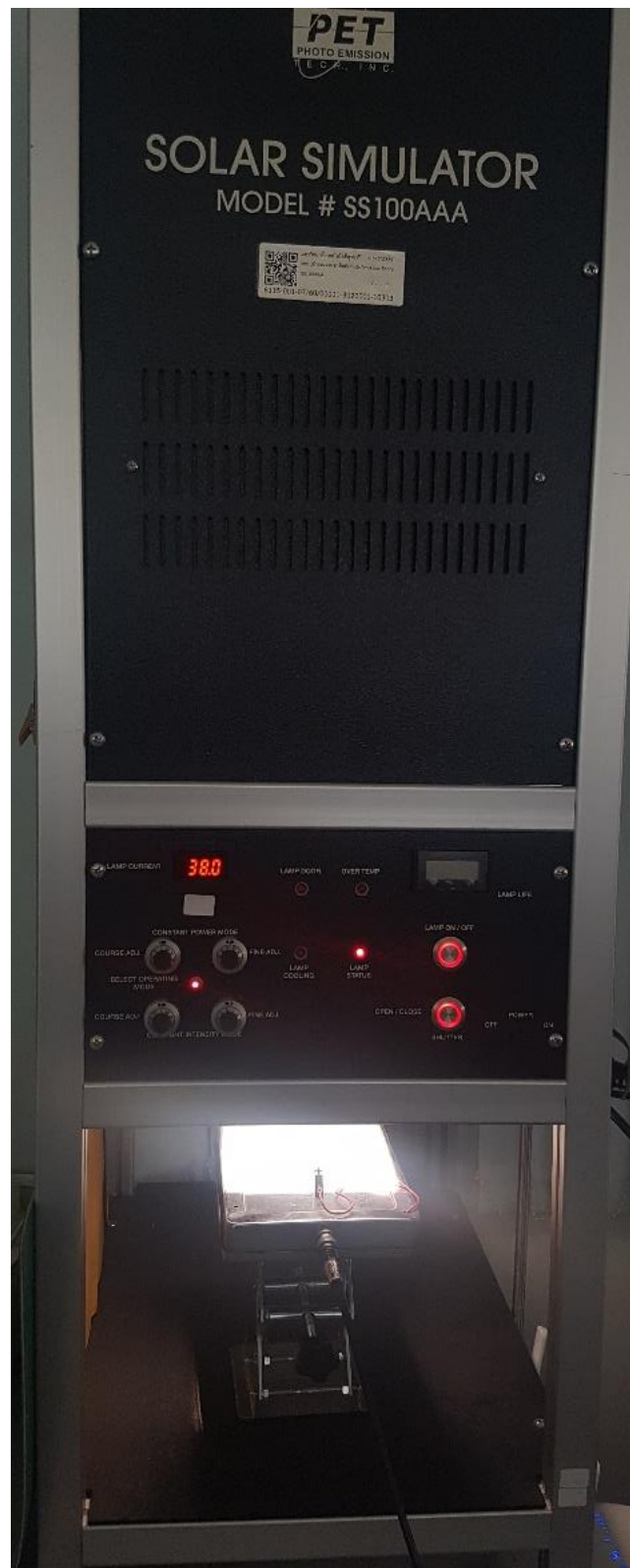
รูปที่ 3.17 เครื่องวัดค่าประสิทธิภาพการแปลงพลังงานของเซลล์แสงอาทิตย์ด้วยระบบจำลองแสงเทียม
