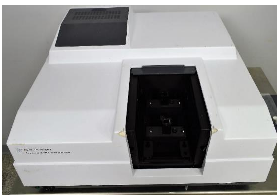
รูปที่ 3.15 เครื่อง UV-Visible spectrophotometer (UV-Vis) รุ่น Cary 300
