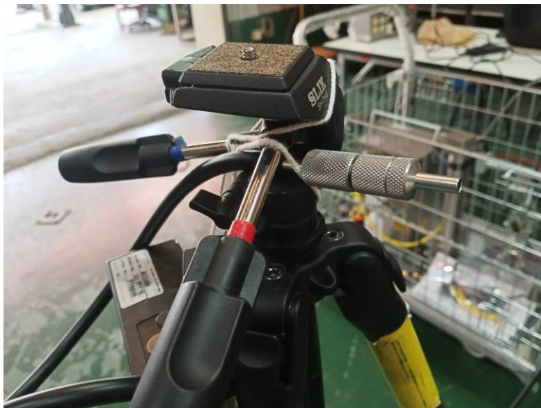
รูปที่ 3.9 การติดตั้ง Nano Particle Sampler (NPS)
