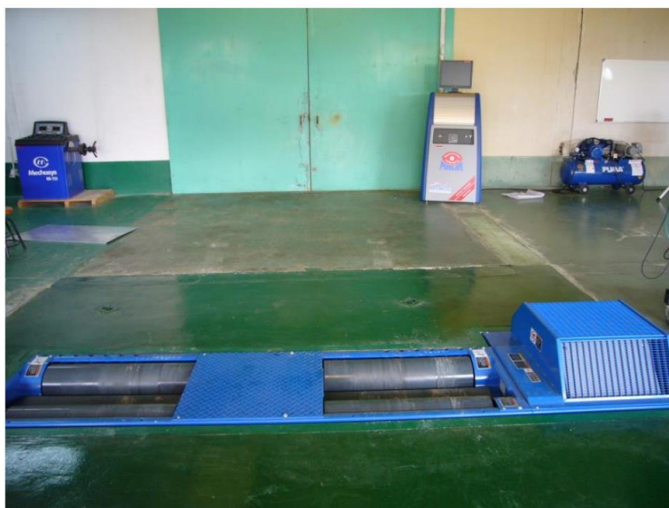
รูปที่ 3.4 เครื่องทดสอบสมรรถนะยานยนต์ Chassis dynamometer รุ่น FPS 2700
