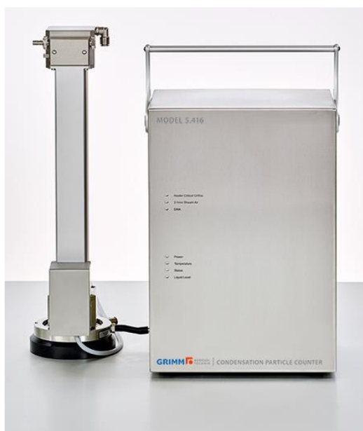
รูปที่ 3.2 Scanning Mobility Particle Sizer with Condensation Particle Counter (SMPS+C) รุ่น GRIMM 5416
