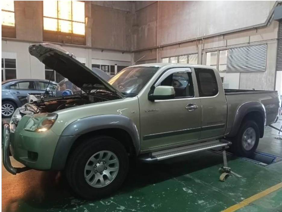
รูปที่ 3.6 การนำรถยนต์ขึ้นทดสอบบนเครื่องทดสอบสมรรถนะยานยนต์
