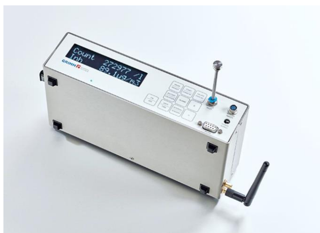
รูปที่ 3.1 Portable Aerosol Spectrometer Dust Detector (PAS) รุ่น GRIMM 11D
