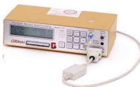
รูปที่ 2.5 Grimm Aerosol Spectrometer model 1.109 (GRIMM, 2010)
