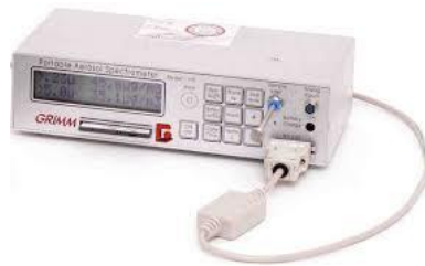
รูปที่ 2.3 Grimm Aerosol Spectrometer model 1.108 (GRIMM, 2010)
