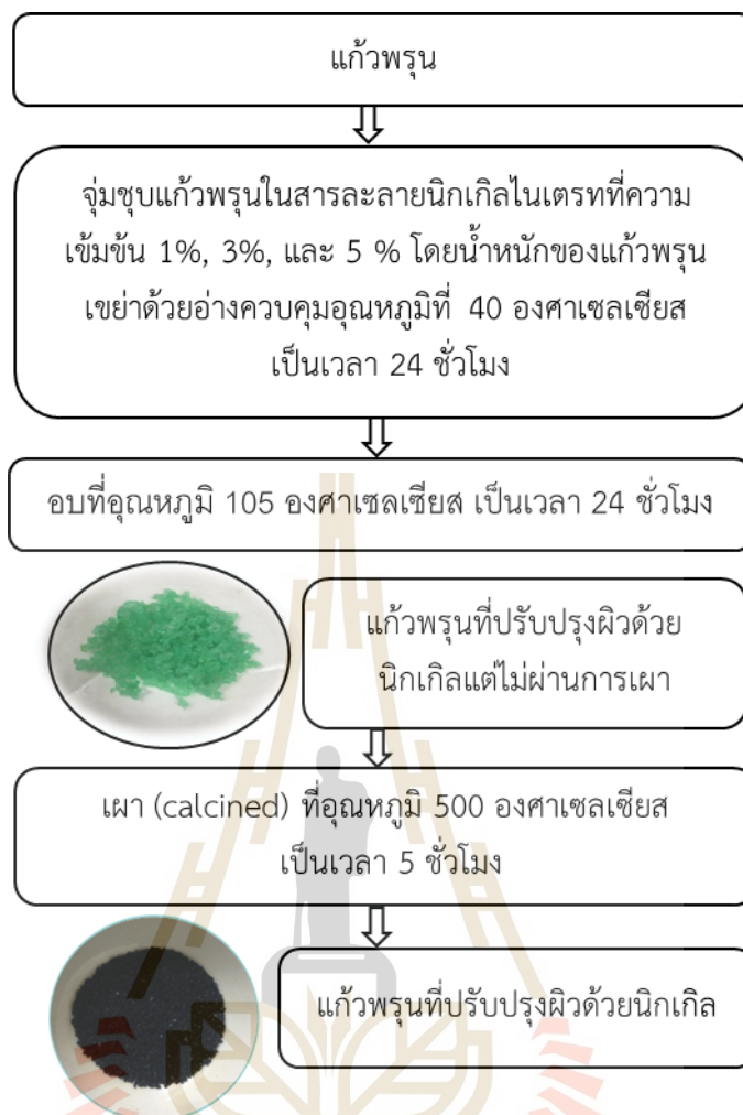
รูปที่ 3.4 การปรับปรุงพื้นที่ผิวแก้วพรุนด้วยนิกเจล
