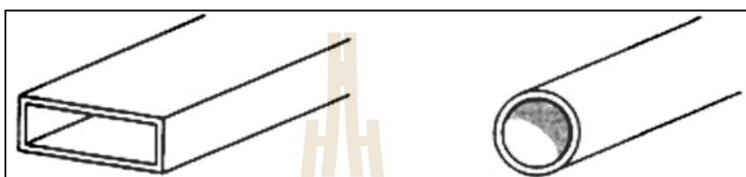
รูปที่ 2.6 ลักษณะของท่อนำคลื่นแบบ (ก) ท่อเหลี่ยมและ (ข) ท่อกลม
