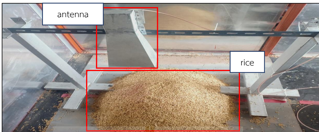
รูปที่ 4.1 การวัดการตอบสนองของคลื่นความถี่ 2.45 GHz
