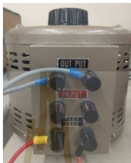
รูปที่ 5.3 หม้อแปลงไฟฟ้าหนึ่งเฟสแบบปรับค่าได้ รุ่น TSB-10M
