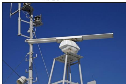
รูปที่ 2.2 สายอากาศท่อนำคลื่นแบบร่องสำหรับระบบเรดาร์เรือพาณิชย์
