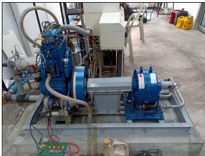
รูปที่ 3.12 การติดตั้งเครื่องยนต์เข้ากับไดนาโมมิเตอร์
