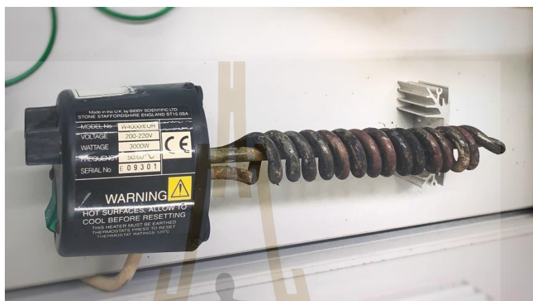
รูปที่ 5.14 โหลดขดลวดความร้อน
