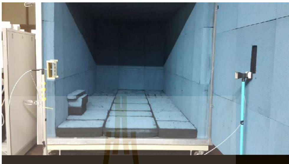
รูปที่ 5.5 ลักษณะการติดตั้งสายอากาศเพื่อทดสอบอัตราขยาย
